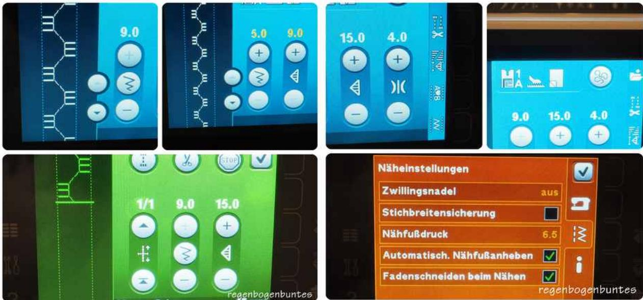
Der Bildschirm ist für diese Maschine ausreichend groß. In gut beschrifteten Menuekarten kann man die Stiche auswählen und verändern. Alle wichtigen Einstellungsmöglichkeiten werden direkt im aktiven Nähmenue angezeigt. Die Darstellung am Bildschirm ist vorbildlich und entspricht sehr gut dem späteren Stichbild und der Darstellung in der Deckelklappe. Hier gibts von mir Bestnoten, einfach, übersichtlich, funktional. Mehr braucht es nicht, gefällt mir sehr gut.
