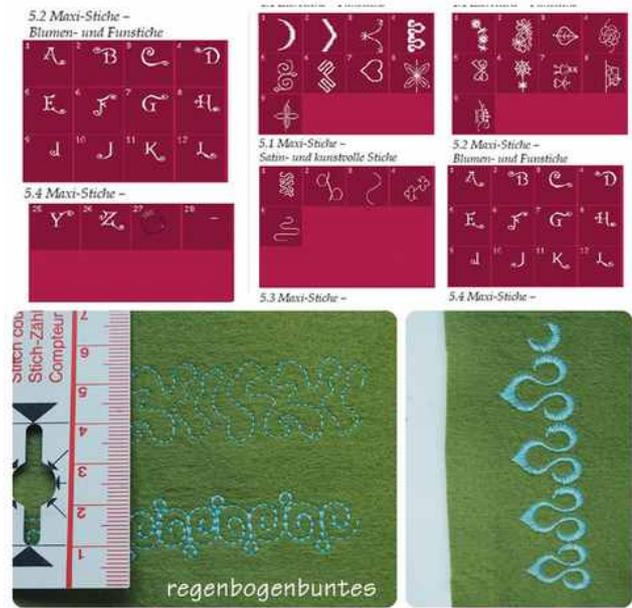
Bei breiten Stichen und auf dehnbaren oder dünnen Stoffen kann es nötig sein, die Oberfadenspannung zu lockern und/oder ein Stickvlies o.ä. unterzulegen. Dies ist bei allen Maschinen zu empfehlen.
